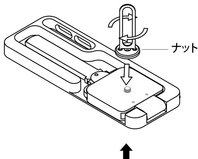
指でボルトを押さえながら、ナットを締め付けます。
