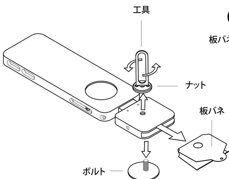
工具を使い、ナットとボルトを外し、板バネを取り出します。
